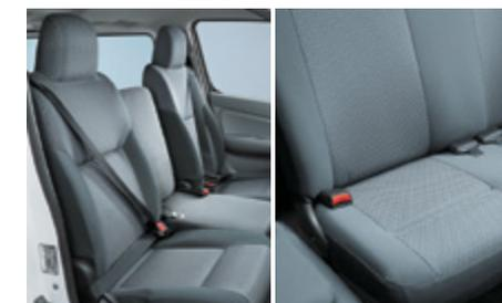
Les sièges du conducteur et du passager avant sont équipés de ceinture de sécurité avec pretensionneurs et limiteur de charges. Sur le modèle Combi, chaque siège arrière est équipé d'une ceinture de sécurité 2 points.
