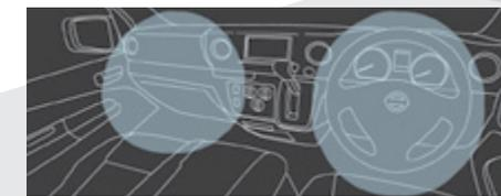
Les airbags SRS (Supplement Restraint System) standard pour le conducteur (sur tous les modèles) et passager avant (sur les modèles sélectionnés) permettent de réduire le risque de blessure en cas d'impact.
