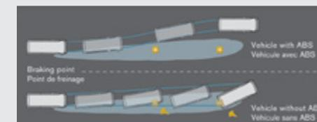
Le système de freinage anti-blocage permet d'éviter le patinage en cas de freinage d'urgence. L'aide au freinage d'urgence (AFU) renforce la performance du freinage en cas de situations d'urgence (sur les modèles sélectionnés).
